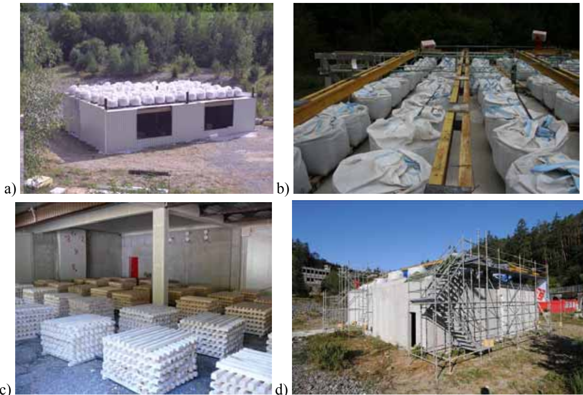
Obr.5 Zatížení a) a b) mechanické pytlí se štěrskem, c) požární dřevěnými hranoly, d) samostatně stojící lešení na měření deformací
